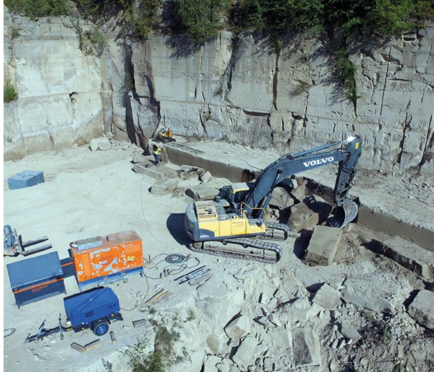
Im Steinbruch Weibern wird seit rund fünf Jahrzehnten Tuffsteinmaterial abgebaut: Hier werden im Tagebau Rohblöcke in einer durchschnittlichen Größe von ca. 250/180/110 cm (Gewicht 1,6 t/pro m 3 ) gewonnen.
