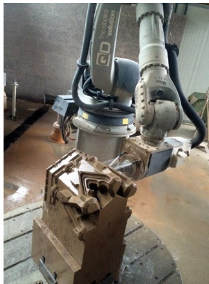
Mit den CNC-Robotern werden mithilfe von diamantbestückten Werkzeugen alle erdenklichen Formen und Strukturen materialschonend gefräst.
