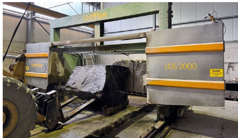
Mit der Blockseilsäge (seit 2002) werden die Rohblöcke mit einem Gewicht bis zu 16 Tonnen in kleinere Tranchen aufgeschnitten.
